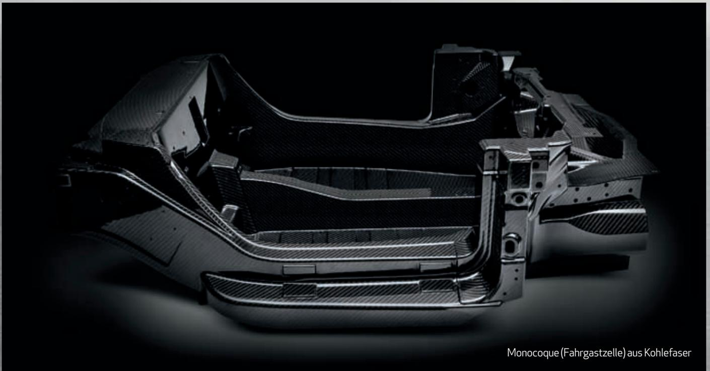
Monocoque (Fahrgastzelle) aus Kohlefaser
