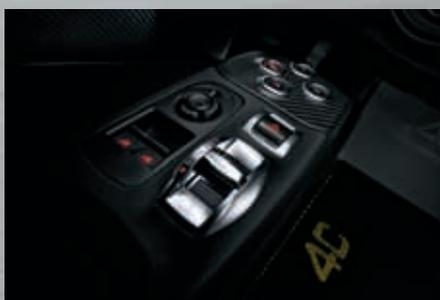
Fahrdynamikregelung Alfa Romeo D.N.A.™, 4-stufig einstellbar:
