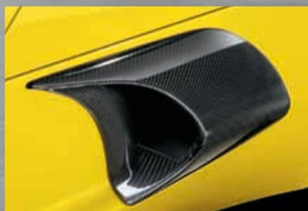
Lufteinlass auf der Fahrerseite für zusätzliche Getriebekühlung, aus Kohlefaser
