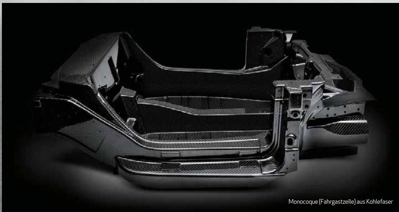
Monocoque (Fahrgastzelle) aus Kohlefaser
