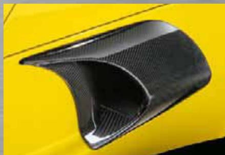
Lufteinlass auf der Fahrerseite für zusätzliche Getriebekühlung, aus Kohlefaser
