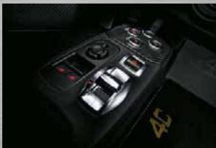
Fahrdynamikregelung Alfa Romeo D.N.A.™, 4-stufig einstellbar:
