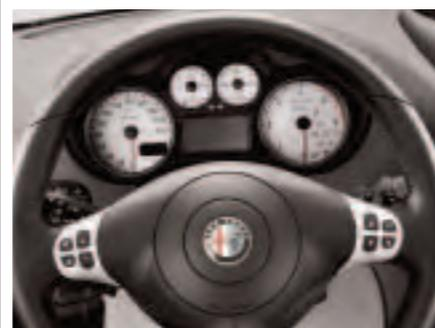
Multifunktionstasten für Radio- und Telefonbedienung am Lenkrad, Sonderausstattung auf Wunsch für alle Versionen (Option 709). Nur in Verbindung mit CONNECT NAV und CONNECT NAV+ (Optionen 903+533/904+533).
