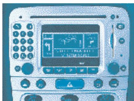
CONNECT™ NAV: Audioanlage mit CD und RDS, GSM-Telefon mit Freisprechfunktion, CONNECT™-Taste mit SOS-Funktion, Navigationssystem mit Piktogrammen. Sonderausstattung auf Wunsch für alle Versionen (Option 903+533). Kartenfach und Dosenhalter entfallen.
