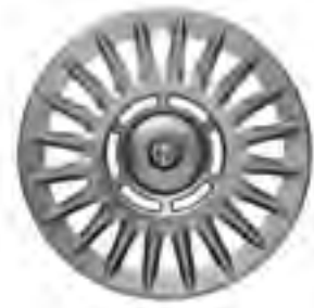
Stahlräder mit Radvollabdeckung, 6J x 15" mit Bereifung 185/65.
