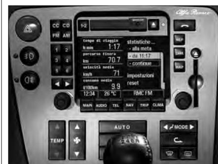
Bordcomputer mit Außentemperaturanzeige, Check-Control und Trip-Computer, serienmäßig für alle Versionen.
