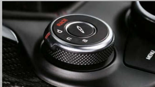
Fahrdynamikregelung Alfa™ DNA Pro, 4-stufig einstellbar
