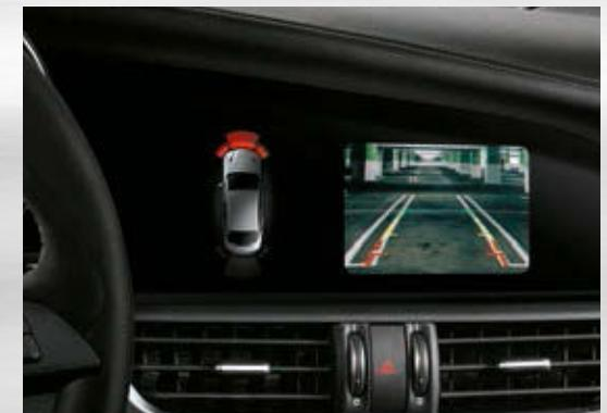
Rückfahrkamera mit dynamischen Führungslinien
