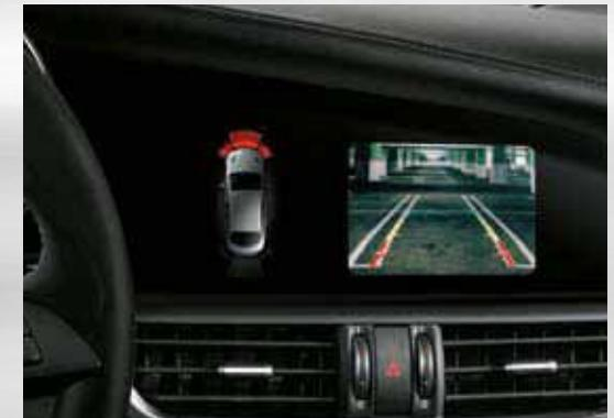
Rückfahrkamera mit dynamischen Führungslinien
