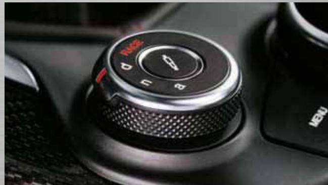
Fahrdynamikregelung Alfa™ DNA Pro, 4-stufig einstellbar
