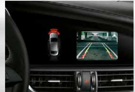
Rückfahrkamera mit dynamischen Führungslinien
