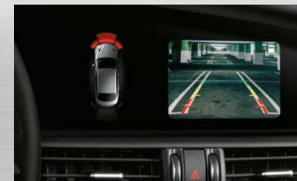
Rückfahrkamera mit dynamischen Führungslinien
