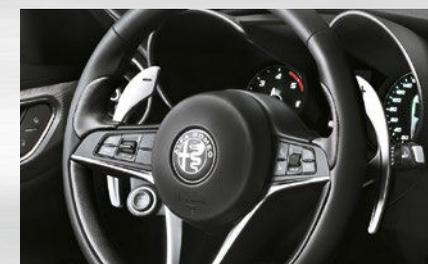
Schaltwippen hinter dem Lenkrad, aus Aluminium
