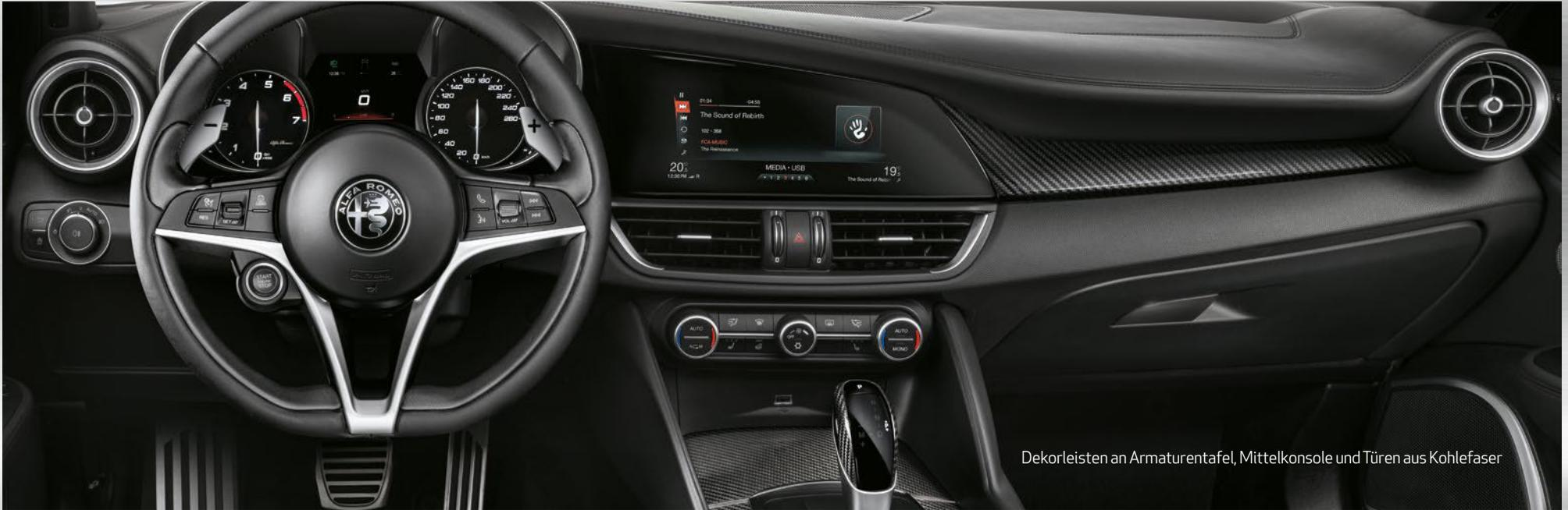
Dekorleisten an Armaturentafel, Mittelkonsole und Türen aus Kohlefaser
