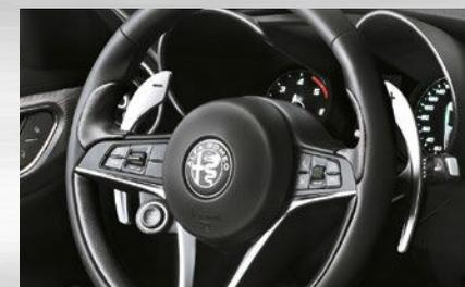
Schaltwippen hinter dem Lenkrad, aus Aluminium
