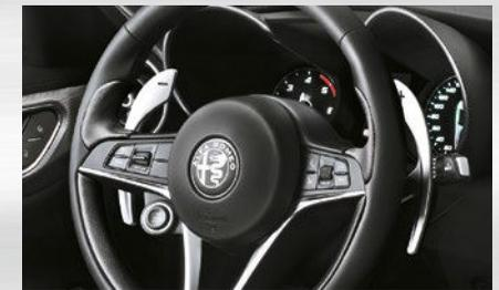
Schaltwippen hinter dem Lenkrad, aus Aluminium
