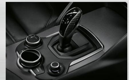
Schalthebelaabdeckung aus Kohlefaser
