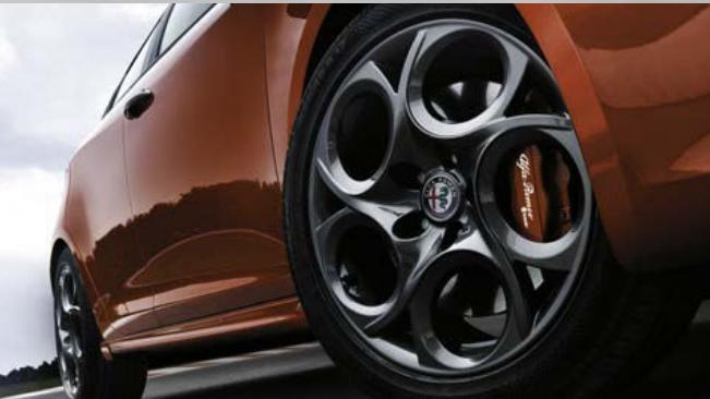
Brembo®-Bremsanlage mit 4-Kolben-Monoblock-Festsattel vorne, Bremssättel rot lackiert
