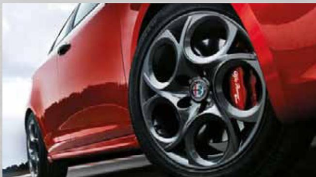
Brembo®-Bremsanlage mit 4-Kolben-Monoblock-Festsattel vorne, Bremssättel rot lackiert
