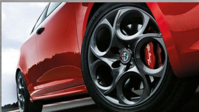
Brembo®-Bremsanlage mit 4-Kolben-Monoblock-Festsattel vorne, Bremssättel rot lackiert
