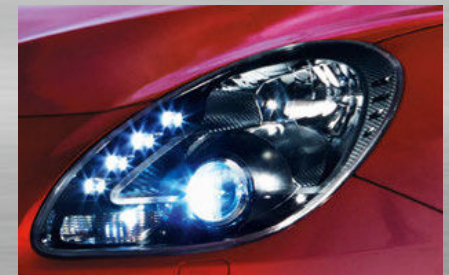
Bi-Xenon-Scheinwerfer mit LED-Tagfahrlicht (DRL) und dynamischem Kurvenlicht (AFS)
