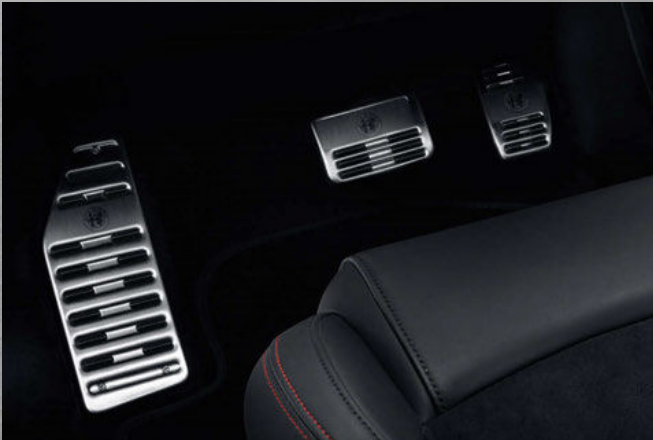
Sportpedale und Fußstütze aus Aluminium
