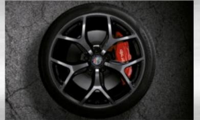
Brembo®-Bremsanlage mit 4-Kolben-Monoblock-Festsattel vorne, Bremssättel rot lackiert
