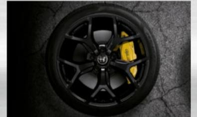
Brembo®-Bremsanlage mit 4-Kolben-Monoblock-Festsattel vorne, Bremssättel gelb lackiert
