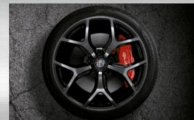
Brembo®-Bremsanlage mit 4-Kolben-Monoblock-Festsattel vorne, Bremssättel rot lackiert
