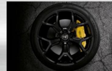
Brembo®-Bremsanlage mit 4-Kolben-Monoblock-Festsattel vorne, Bremssättel gelb lackiert
