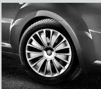
Stahlräder mit Radvollabdeckung, 7J x 16", mit Bereifung 195/55, serienmäßig für Version MiTo
