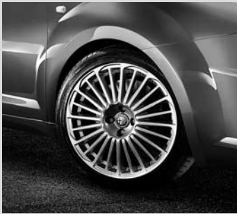
Leichtmetallräder „Elegante I“, 7J x 17", mit Bereifung 205/45
