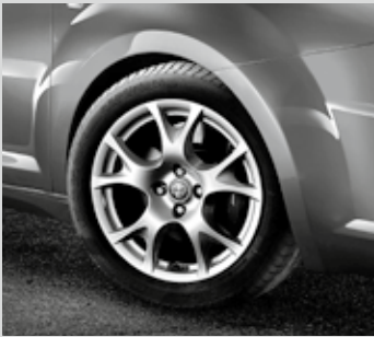
Leichtmetallräder „Sport“, 7J x 16", mit Bereifung 195/55
