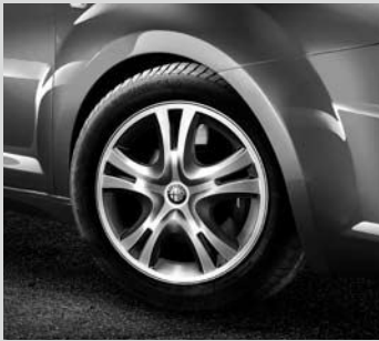
Leichtmetallräder „Elegante“, 7J x 16", mit Bereifung 195/55
