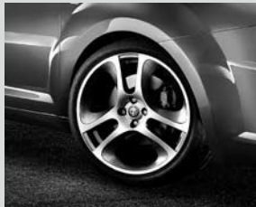
Leichtmetallräder „Supersport“, 7,5J x 18", mit Bereifung 215/40
