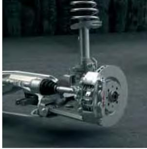
Der MiTo verlangt von seinem Radaufhängungssystem ein wenig mehr: umfassende Sicherheit plus maximalen Fahrspaß. Für die Lösung dieser Aufgabe steht modernste Technik zur Verfügung: Stoßdämpfer mit Gegendruckfedern, eine Vorderradaufhängung in McPherson-Bauweise und eine Verbundlenker-Hinterachse. Zusätzlich ist serienmäßig die dynamische Fahrstabilitätskontrolle (VDC) mit an Bord.
