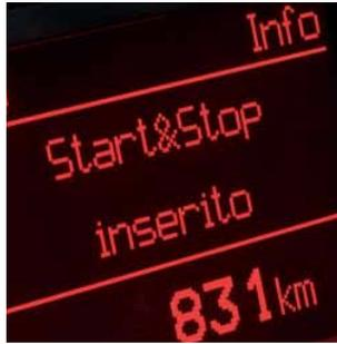
Der MiTo bietet ein Maximum an Fahrdynamik in Verbindung mit höchster Umweltverträglichkeit. Aus diesem Grund entsprechen alle Motoren der Norm Euro 5. Und nicht nur das: Auch ein innovatives Start&Stopp-System ist verfügbar. Bei einem kurzen Halt z. B. im Stadtverkehr wird der Motor automatisch ausgeschaltet und anschließend wieder gestartet. Das Ergebnis: eine beachtliche Reduktion von Kraftstoffverbrauch, Emissionen und Motorengeräuschen.
