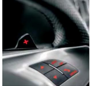
Das Doppelkupplungsgetriebe ALFA TCT hat vier Positionen: Parken (P), Rückwärtsgang (R), Leerlauf (N) und Fahren (D). Zusätzlich lässt sich über den Schalthebel der sequenzielle Modus auswählen. Hier kann entweder über die Up- und Down-Funktion am Schalthebel oder über die auf Wunsch verfügbaren Schaltwippen am Lenkrad manuell geschaltet werden.
