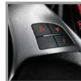
Multifunktionsknöpfe für Radio- und Telefonbedienung am Lenkrad
