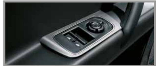
Fensterheber elektrisch, vorne mit Automatikvorrichtung
