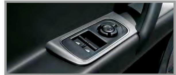
Fensterheber elektrisch, vorne mit Automatikvorrichtung
