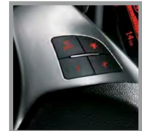
Multifunktionsknöpfe für Radio- und Telefonbedienung am Lenkrad
