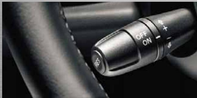
Cruise Control (automatische Fahrgeschwindigkeitsregelung)
