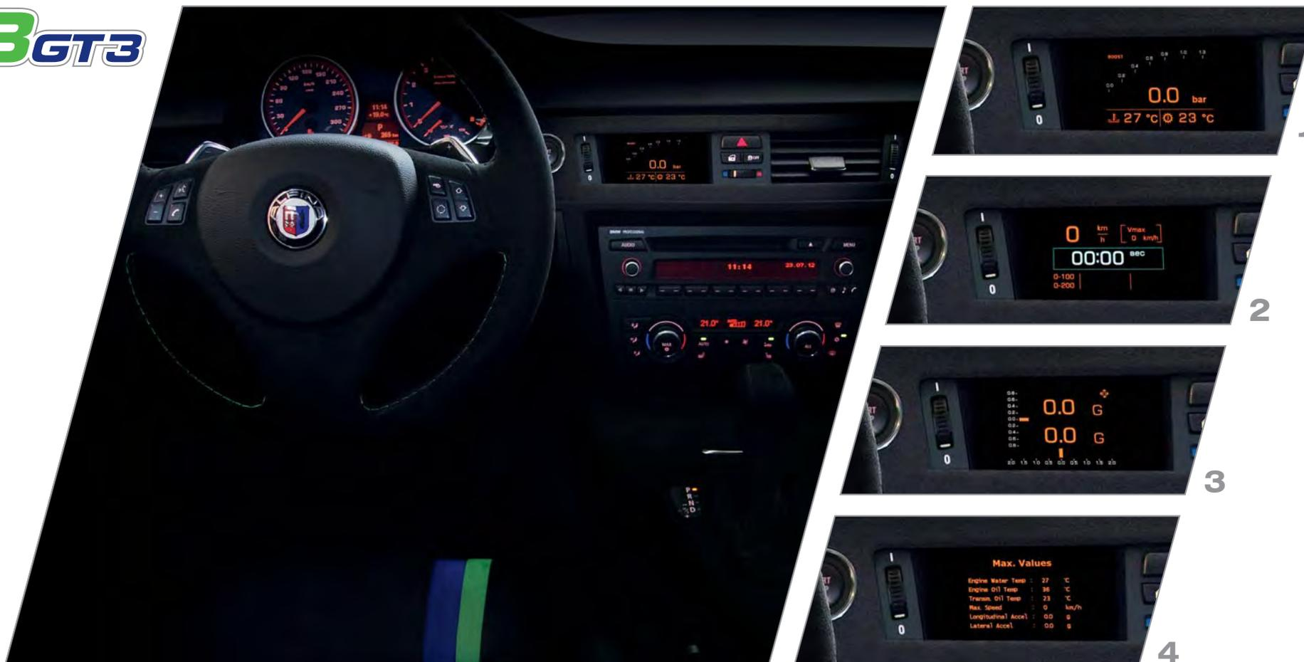
+ **ANZEIGEMODI 1:** • Ladedruckbalken • Ladedruck • Kühlmitteltemperatur (Wasser) • Getriebeöltemperatur
