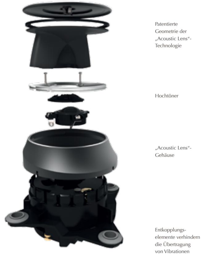
Patenterte Geometrie der „Acoustic Lens“-Technologie
