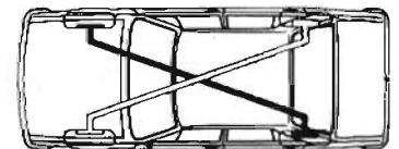
Das Diagonal-Zweikreis-Bremssystem ermöglicht bei Ausfall eines Bremskreises unveränderte Bremskraftverteilung zwischen Vorder- und Hinterachse. An beiden Achsen bleibt eine Bremswirkung von 50% erhalten.
