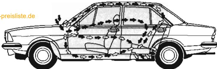
Das schnellwirkende Heizungs- und Belüftungssystem des Audi 80. Vollständiger Luftaustausch in 20 Sekunden.
