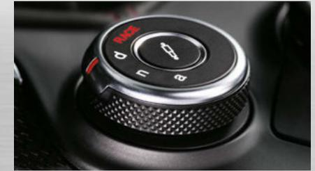
Fahrdynamikregelung Alfa™ DNA Pro, 4-stufig einstellbar
