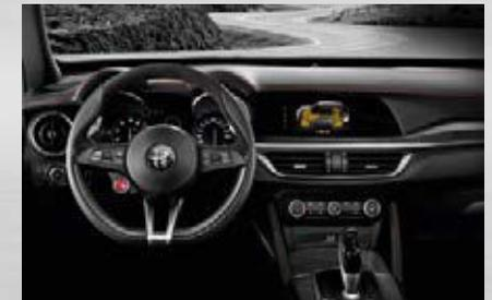
Quadrifoglio-Lenkrad mit rotem Motorstartknopf, mit Alcantara® und LUSO-Leder bezogen, Dekoreinsätze aus Kohlefaser, untere Speichen in Aluminium-Optik, Lenkrad unten abgeflacht
