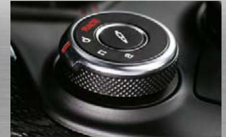
Fahrdynamikregelung Alfa™ D.N.A. Pro, 4-stufig einstellbar
