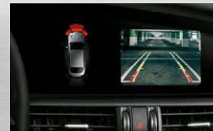
Rückfahrkamera mit dynamischen Führungslinien
