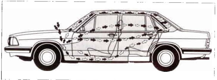
Das temperaturkonstante Heizungs- und Belüftungssystem mit Breitbanddüsen und Schnellregeldeckel für kühlen Kopf und warme Füße.
