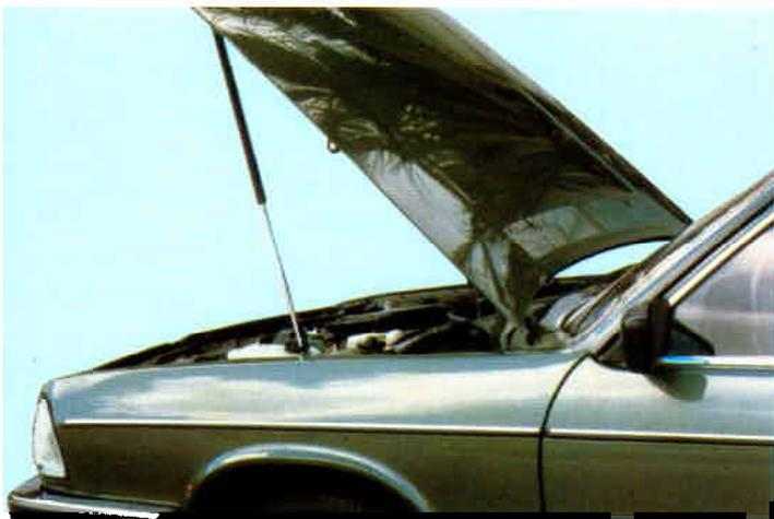
Motorhaubenfeststellung mit Gasdruckfeder (GL).
