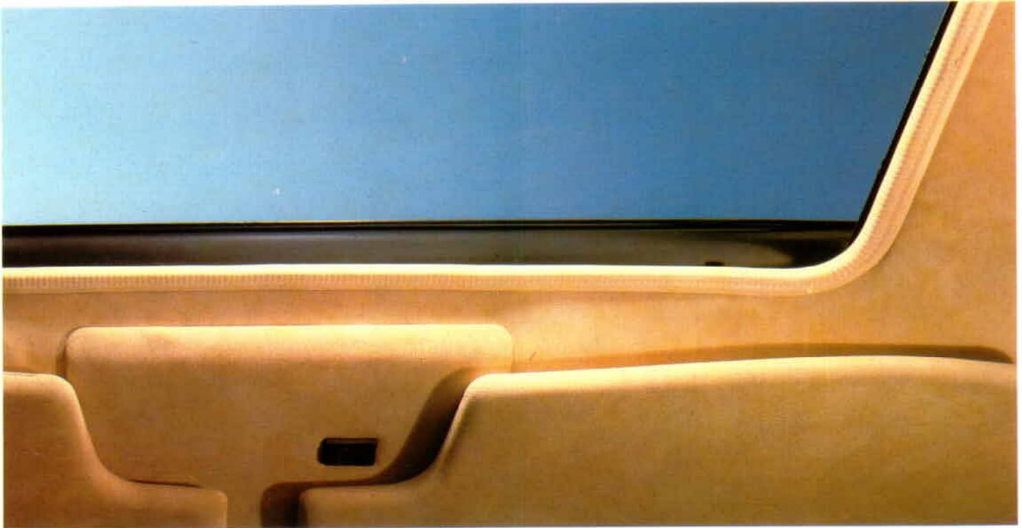
Schiebe-Ausstelldach, auf Wunsch mit elektrischem Antrieb.
