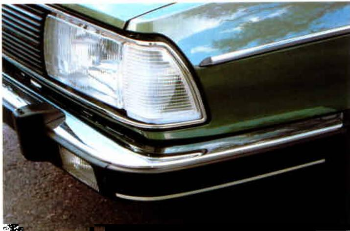
Neue Stoßfänger mit breiter Stoßleiste (GL).
