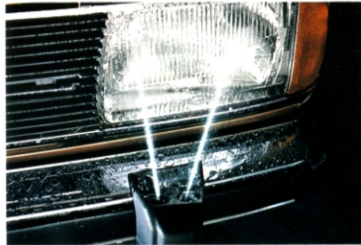
Die Scheinwerfer-Reinigungsanlage gibt immer sicheres Licht.
