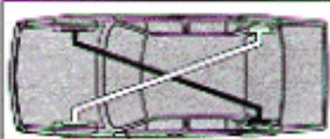
*Beim Diagonal-Zweikreis-Bremssystem bleibt auch bei Ausfall eines Bremskreises die Bremskraftverteilung zwischen Vorder- und Hinterachse unverändert. An beiden Achsen verbleibt eine Bremswirkung von 50%.*
