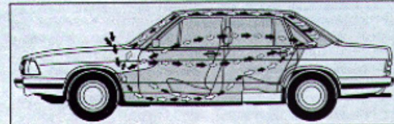
Das temperaturkonstante Heizungs- und Belüftungssystem mit Breitbanddüsen und Schnellregeleffekt – für kalten Kopf und warme Füße.
