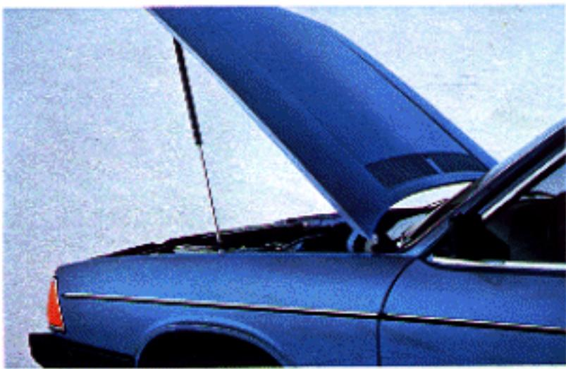
Motorhaubenfeststellung mit Gasdruckfeder. (GL)
