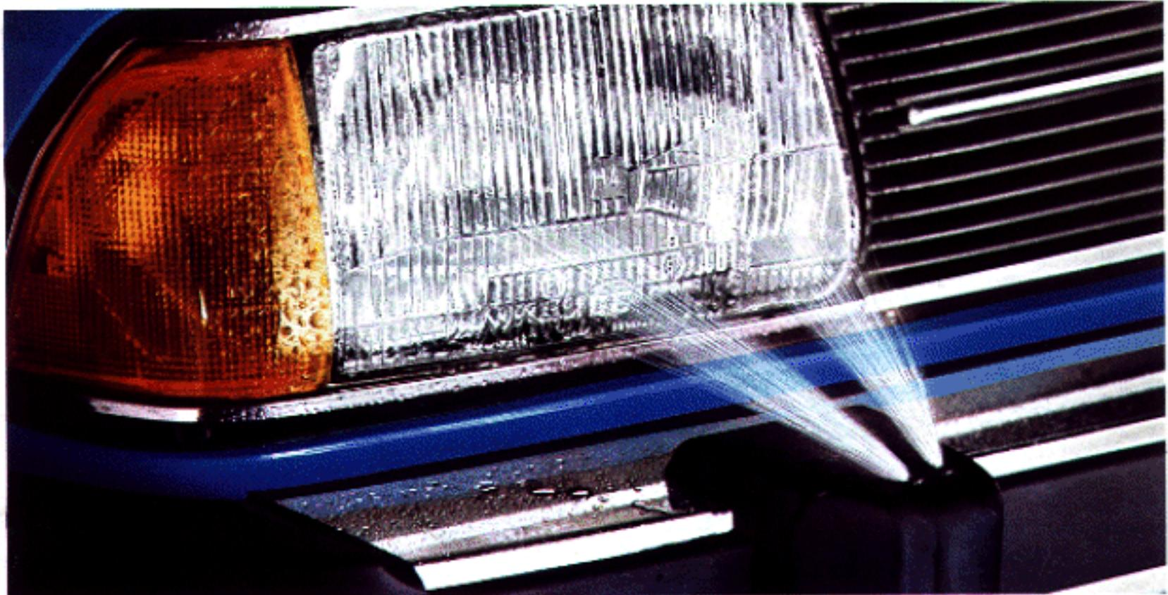
Die Scheinwerfer-Reinigungsanlage für sichere Sicht.
