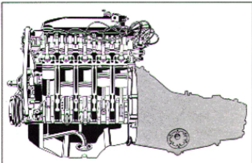
Der 100-kW-(136 PS nach DIN)Fünfzylinder-Motor besticht durch hohe Laufkultur.
