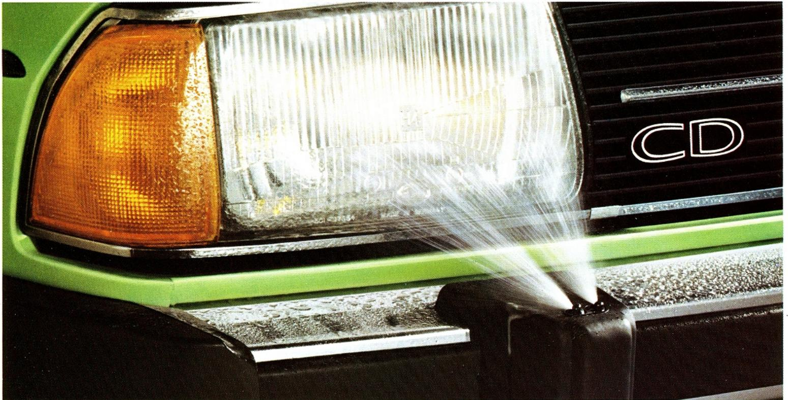
Die Scheinwerfer-Reinigungsanlage für sichere Sicht.
