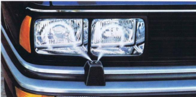
Scheinwerfer-Reinigungsanlage für sichere Sicht.
