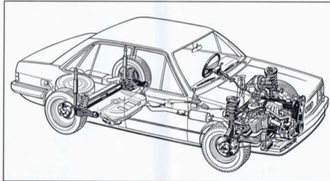
Das Audi 200-Fahrwerk. Mit langem Radstand und breiter Spur und Scheibenbremsen vorn und hinten. Mit Federbeinen vorn und Torsionskurbel hinterachse. Mit Frontantrieb und sehr guter Abstimmung von Dämpfung und Federung.
