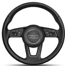
Umfänge wie Lederlenkrad im 3-Speichen-Design mit Multifunktion plus; Lenkradkranz zusätzlich beheizbar. Anstelle der frei programmierbaren Taste (auf der rechten Seite) ist die Taste zur Bedienung der Lenkradheizung verbaut. Bei gleichzeitiger Bestellung des Audi virtual cockpit bekommt das Lenkrad eine spezifische Multifunktionstasten-Belegung.
