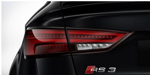
Brems-, Schluss- und Blinkleuchten in LED-Technologie mit geringem Energieverbrauch; Heckkennzeichenleuchten in LED-Technologie; dynamisches Blinklicht mit Rückfahr- und Nebelschlussleuchten; mit adaptivem Bremslicht, Blinken des Bremslichts bei einer Notbremsung, um den nachfolgenden Verkehr zu warnen, automatische Aktivierung des Warnblinkers bei Stillstand
