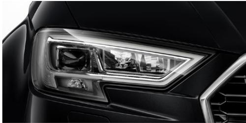
markante und prägnante Lichtsignatur im Tag-und-Nacht-Design. Die LED-Scheinwerfer sorgen für tageslichtähnliche und präzise Ausleuchtung der Fahrbahn. Für mehr Sicherheit und Komfort; geringer Energieverbrauch, hohe Lebensdauer; LED-Heckleuchten mit dynamischem Blinklicht
