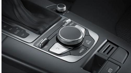
MMI-Bedienkonzept, bestehend aus elektrisch ausfahrbarem 7-Zoll-Farbdisplay (800 × 480), separatem MMI-Bedienteil und Car-Menü
