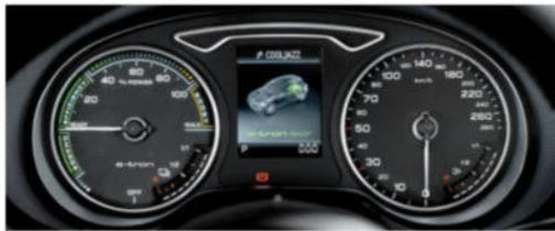
zur Anzeige der Fahrzustände im A3 Sportback 40 e-tron (rein elektrisches Fahren oder Fahren mit dem Verbrennungsmotor, Rekuperieren, Boosten)
