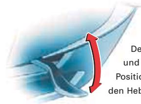
**[34] Hebel für verstellbare Lenksäule**
