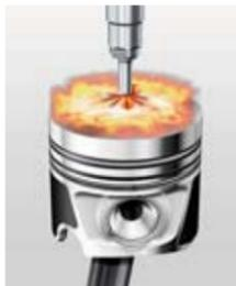
**Die Piezo-Injektoren** im 3.0 TDI öffnen und schließen sich innerhalb von Bruchteilen von Millisekunden und spritzen mehrmals mit bis zu 2.000 bar in den Brennraum ein. Bei einem Einspritzvorgang werden teilweise winzigste Mengen von weniger als einem tausendstel Gramm eingespritzt.
