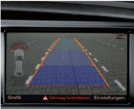
**Einparkhilfe plus mit Rückfahrkamera**
