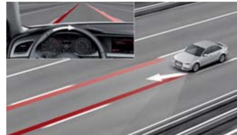
**Audi active lane assist\*** unterstützt Sie ab einer Geschwindigkeit von ca. 60 bis 250 km/h bei der Spurhaltung z. B. durch einen sanften korrigierenden Lenkeingriff. Hierfür stehen Ihnen im MMI zwei Systemeinstellungen zur Wahl (Lenkzeitpunkt früh oder spät).
