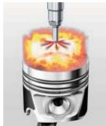
**Die Voreinspritzung** führt zu einer „weichen“ Verbrennung und damit zu einer ausgezeichneten Verbrennungskustik und einem angenehmen Motorlauf.
