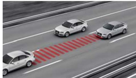
**adaptive cruise control\***: Die automatische Distanzregelung erkennt durch einen Radarsensor vorausfahrende Fahrzeuge. Innerhalb der Systemgrenzen wird durch automatisches Bremsen und Beschleunigen ein vom Fahrer eingestellter Abstand zum vorausfließenden Verkehr konstant gehalten.
