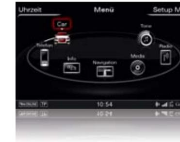
**Car:** Diese Funktion ermöglicht Ihnen das direkte Ansteuern von Fahrerassistenzsystemen, Fahrzeugeinstellungen, Klima- und Service-Funktionen.
