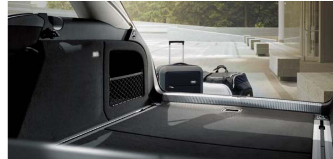
Der Kofferraum im Audi A4 Avant hat ein Volumen von 490 Litern, mit umgeklappter Rückbank sogar von 1.430 Litern. Verzurrösen, Taschenhaken, ein Staufach mit Netz und eine 12-Volt-Steckdose bieten weitere Möglichkeiten, den Gepäckraum individuell zu nutzen.
