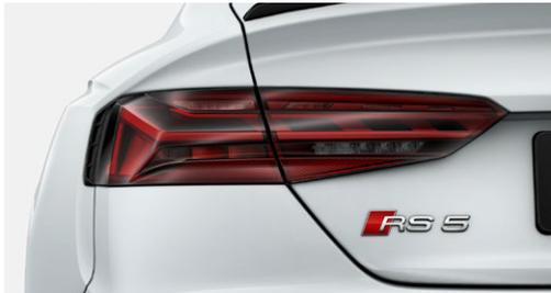
Über die Funktionen der LED-Heckleuchte hinaus überzeugt die Heckleuchte durch den markanten dynamischen und gut wahrnehmbaren Verlauf des Blinklichts. Ein Band von LEDs wird segmentweise im Takt von wenigen Millisekunden nacheinander angesteuert und läuft beim Blinken immer zur Außenseite in Abbiegerichtung.
