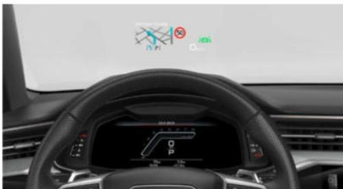
projiziert auf Wunsch die Geschwindigkeit und weitere fahrerrelevante Informationen aus optional erhältlichen Ausstattungen wie Assistenzsystemen und Navigation sowie Warnhinweise, RS-spezifische Anzeigen und Schaltblitzfunktion in den direkten Sichtbereich des Fahrers; in Höhe einstellbar; ermöglicht kontraststarke, mehrfarbige Anzeige mit reduzierter Blickabwendung von der Fahrbahn
