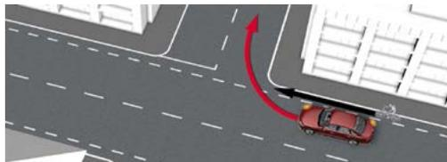
Die Spurwechselwarnung unterstützt dabei, das Verkehrsgeschehen hinter dem Fahrzeug zu überwachen. Zwei zusätzlich im Heck verbaute Radarsensoren erfassen Fahrzeuge, die sich seitlich von hinten nähern oder im Verkehr mitschwimmen. Es können der Abstand sowie die Geschwindigkeitsdifferenz gemessen und analysiert werden.
