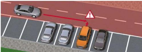
Der Querverkehrsassistent hinten kann beim Rückwärtsfahren bis 10 km/h (z. B. beim Ausparken) vor einer möglichen Kollision mit herannahenden, bewegten Objekten (wie z. B. Autos im Querverkehr) warnen. Mithilfe der Radarsensoren wird beim Ausparken das rückwärtige und seitliche Fahrzeugumfeld überwacht.
