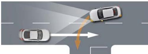
Der Abbiegeassistent überwacht mittels der Daten des Radarsensors und der Frontkamera die Gegenfahrbahn, sobald der Blinker gesetzt wird. Bei Anfahrvorgängen oder beim langsamen Fahren bis zu einer Geschwindigkeit von max. 10 km/h kann das System durch einen Bremsengriff das Risiko einer Kollision mit entgegenkommenden Fahrzeugen verringern.
