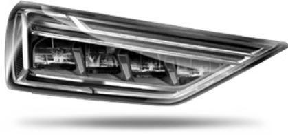
LED-Scheinwerfer sorgen für eine tageslichtähnliche Ausleuchtung der Fahrbahn und damit für mehr Sicherheit und Komfort. Sie zeichnen sich durch geringen Energieverbrauch und eine hohe Lebensdauer aus. Die Scheinwerfer verfügen über folgenden Funktionsumfang: Tagfahrlicht, Abblendlicht, Fernlicht, Positionslicht, Blinklicht in Glühlampentechnik sowie Allwetterlicht (zur Verringerung der Eigenblendung bei schlechten Sichtverhältnissen).
