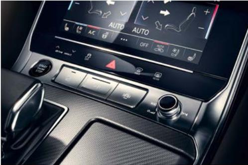
Bedientastenleiste in der Mittelkonsole und Lichttasten in Schwarz glänzend, Bedientasten- sowie Lichttastenleiste mit haptischem Feedback; Lichttastenleiste inklusive Annäherungssensorik; Bedientasten Fahrerassistenzsysteme, Tasten für Parkbremse, Auto-Hold-Funktion, Zentralverriegelung vorn und hinten, Verriegelung hinten, Rahmen um die Türinnenbetätigung sowie Fensterheber in Aluminiumoptik
