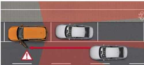
Werden bei einem stehenden Fahrzeug die Türen geöffnet, warnt die Ausstiegswarnung vor möglichen Kollisionen mit erkannten Verkehrsteilnehmern, wie z. B. Fahrzeugen, die sich von hinten nähern.
