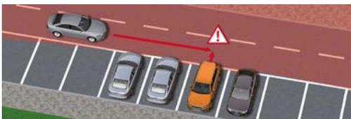
Der Querverkehrsassistent hinten kann beim Rückwärtsfahren bis 10 km/h (z. B. beim Ausparken) vor einer möglichen Kollision mit herannahenden, bewegten Objekten (wie z. B. Autos im Querverkehr) warnen. Mithilfe der Radarsensoren wird beim Ausparken das rückwärtige und seitliche Fahrzeugumfeld überwacht.
