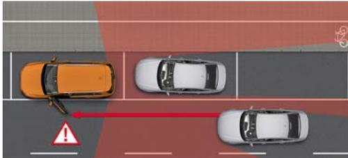
Rücksicht beim Aussteigen. Werden bei einem stehenden Fahrzeug die Türen geöffnet, warnt die Ausstiegswarnung vor möglichen Kollisionen mit erkannten Verkehrsteilnehmern wie z. B. Fahrzeugen, die sich von hinten nähern. Wenn eine als kritisch eingestufte Situation erkannt wird, leuchten bereits beim Betätigen des Türöffners die Warnleiste in der Tür und die LED-Anzeige am Außenspiegel auf der jeweiligen Fahrzeugseite auf.
