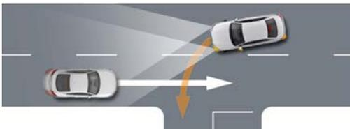
Der Abbiegeassistent überwacht mittels der Daten des Radarsensors und der Frontkamera die Gegenfahrbahn, sobald der Blinker gesetzt wird. Bei Anfahrvorgängen oder beim langsamen Fahren bis zu einer Geschwindigkeit von max. 10 km/h kann das System durch einen Bremsingriff das Risiko einer Kollision mit entgegenkommenden Fahrzeugen verringern.
