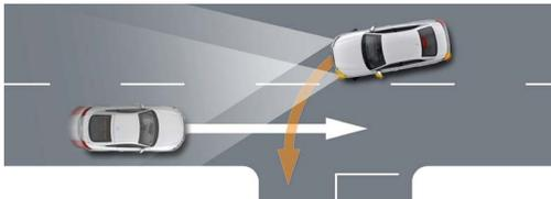
Der Abbiegeassistent kann bei Anfahrvorgängen oder bei langsamem Fahren bis zu einer Geschwindigkeit von 10 km/h durch einen Bremsengriff verhindern, dass das Fahrzeug beim Linksabbiegen mit einem entgegenkommenden Fahrzeug kollidiert. Sobald der Fahrer den Blinker setzt, überwacht der Abbiegeassistent die Gegenfahrbahn. Dafür nutzt das System die Daten von Laserscanner, Radarsensoren und Frontkamera.
