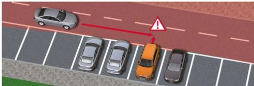
Der Querverkehrsassistent hinten kann beim Rückwärtsfahren bis 10 km/h vor einer möglichen Kollision mit näherndem Querverkehr warnen. Das System überwacht beim Ausparken das rückwärtige und seitliche Fahrzeugumfeld. Erkannt werden herannahende Objekte wie z. B. Autos. Das System informiert den Fahrer optisch und kann bei der Rückwärtsfahrt in als besonders kritisch erkannten Situationen zusätzlich durch ein akustisches Signal und durch einen Bremsruck warnen.
