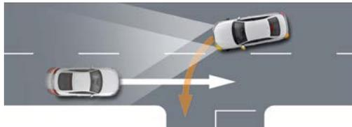
Der Abbiegeassistent kann bei Anfahrvorgängen oder bei langsamem Fahren bis zu einer Geschwindigkeit von 10 km/h durch einen Bremseneingriff verhindern, dass das Fahrzeug beim Linksabbiegen mit einem entgegenkommenden Fahrzeug kollidiert. Sobald der Fahrer den Blinker setzt, überwacht der Abbiegeassistent die Gegenfahrbahn. Dafür nutzt das System die Daten von Laserscanner, Radarsensoren und Frontkamera.
