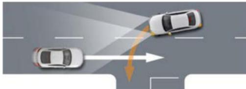
Der Abbiegeassistent kann bei Anfahrvorgängen oder bei langsamem Fahren bis zu einer Geschwindigkeit von 10 km/h durch einen Bremsingriff verhindern, dass das Fahrzeug beim Linksabbiegen mit einem entgegenkommenden Fahrzeug kollidiert. Sobald der Fahrer den Blinker setzt, überwacht der Abbiegeassistent die Gegenfahrbahn. Dafür nutzt das System die Daten von Laserscanner, Radarsensoren und Frontkamera.
