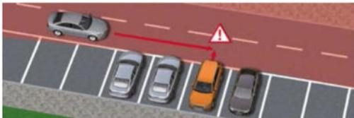
Der Querverkehrsassistent hinten kann beim Rückwärtsfahren bis 10 km/h vor einer möglichen Kollision mit sich näherndem Querverkehr warnen. Das System überwacht beim Ausparken das rückwärtige und seitliche Fahrzeugumfeld. Erkannt werden herannahende Objekte wie z. B. Autos. Das System informiert den Fahrer optisch und kann bei der Rückwärtsfahrt in als besonders kritisch erkannten Situationen zusätzlich durch ein akustisches Signal und durch einen Bremsruck warnen.
