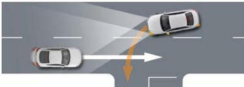
Der Abbiegeassistent kann bei Anfahrvorgängen oder bei langsamem Fahren bis zu einer Geschwindigkeit von 10 km/h durch einen Bremsengriff verhindern, dass das Fahrzeug beim Linksabbiegen mit einem entgegenkommenden Fahrzeug kollidiert. Sobald der Fahrer den Blinker setzt, überwacht der Abbiegeassistent die Gegenfahrbahn. Dafür nutzt das System die Daten von Laserscanner, Radarsensoren und Frontkamera.
