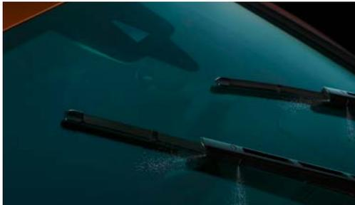
adaptives Scheibenwischsystem für freie Sicht auch während des Wischvorgangs: Reinigungsflüssigkeit wird je nach Wischrichtung direkt vor die Wischerblätter gesprüht und ohne Verzögerung weggewischt; beheizbar
