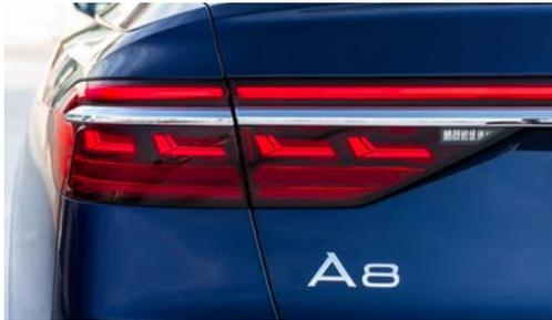
Die innovative OLED-Technologie der Heckleuchten bietet durch die sehr homogene Ausleuchtung ein neuartiges Lichtdesign und ermöglicht eine dynamische Lichtinszenierung der Coming-Home-/Leaving-Home-Funktion.
