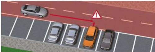
Der Querverkehrsassistent hinten kann beim Rückwärtsfahren bis 10 km/h vor einer möglichen Kollision mit sich näherndem Querverkehr warnen. Das System überwacht beim Ausparken das rückwärtige und seitliche Fahrzeugumfeld. Erkennt werden herannahende Objekte wie z. B. Autos. Das System informiert den Fahrer optisch und kann bei der Rückwärtsfahrt in als besonders kritisch erkannten Situationen zusätzlich durch ein akustisches Signal und durch einen Bremsruck warnen.
