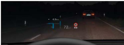
projiziert auf Wunsch bestimmte Warnhinweise, Geschwindigkeit und weitere fahrerrelevante Informationen von Assistenzsystemen bzw. der Navigation in den direkten Sichtbereich des Fahrers und erlaubt so, die Blickabwendung von der Fahrbahn zu reduzieren; kontraststarke, mehrfarbige Anzeige
