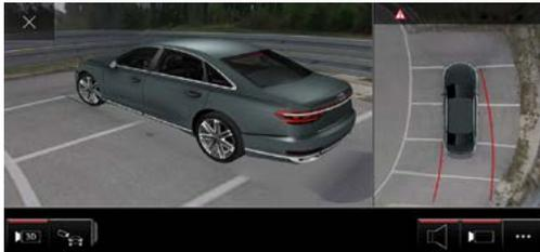
4 weitwinklige Umgebungskameras decken den gesamten Bereich unmittelbar rund um das Fahrzeug ab und ermöglichen eine Vielzahl verschiedener Ansichten für noch komfortableres Rangieren:
