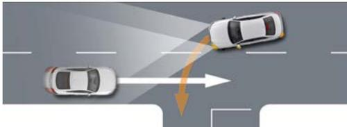
Der Abbiegeassistent kann bei Anfahrvorgängen oder bei langsamem Fahren bis zu einer Geschwindigkeit von 10 km/h durch einen Brems Eingriff verhindern, dass das Fahrzeug beim Linksabbiegen mit einem entgegenkommenden Fahrzeug kollidiert. Sobald der Fahrer den Blinker setzt, überwacht der Abbiegeassistent die Gegenfahrbahn. Dafür nutzt das System die Daten von Laserscanner, Radarsensoren und Frontkamera.
